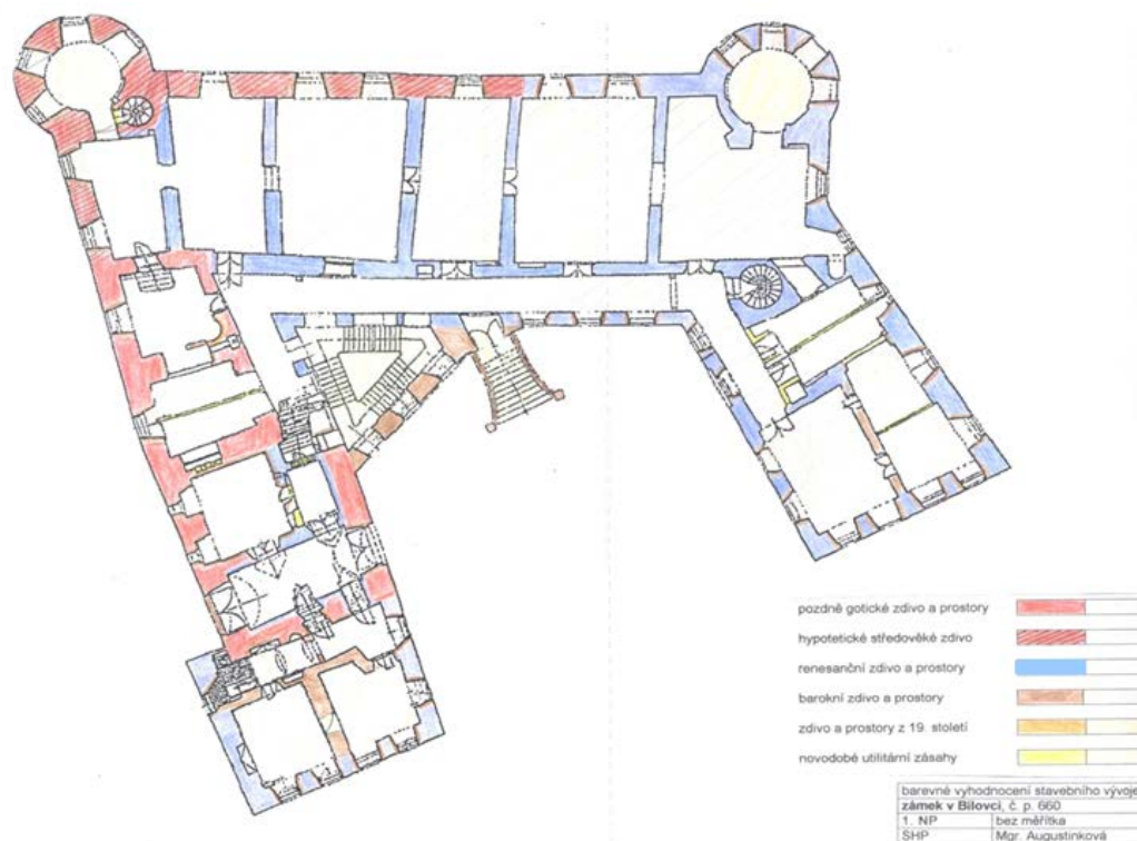
Obr. 8.4: Barevné vyhodnocení stavebního vývoje
