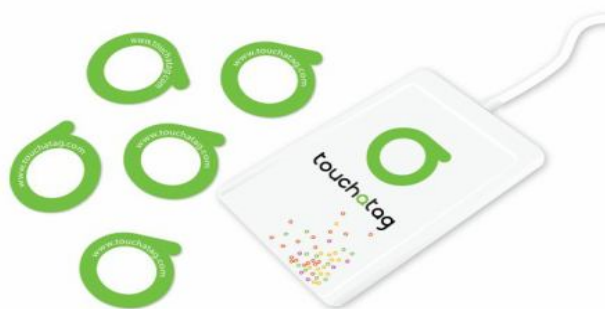
Obrázek 2.4: TouchATag značky a čtečka připojená k počítači
